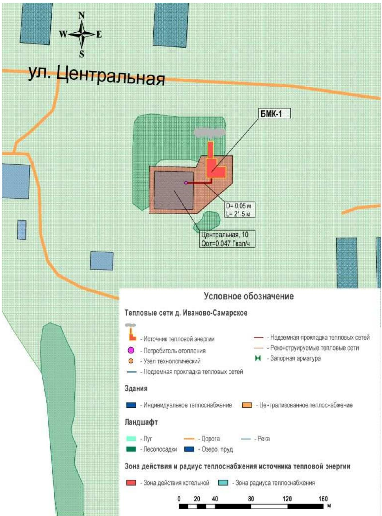
Рис. 4.2. Перспективная зона действия системы теплоснабжения и источника тепловой энергии – котельная БМК-1 д. Иваново-Самарское.
