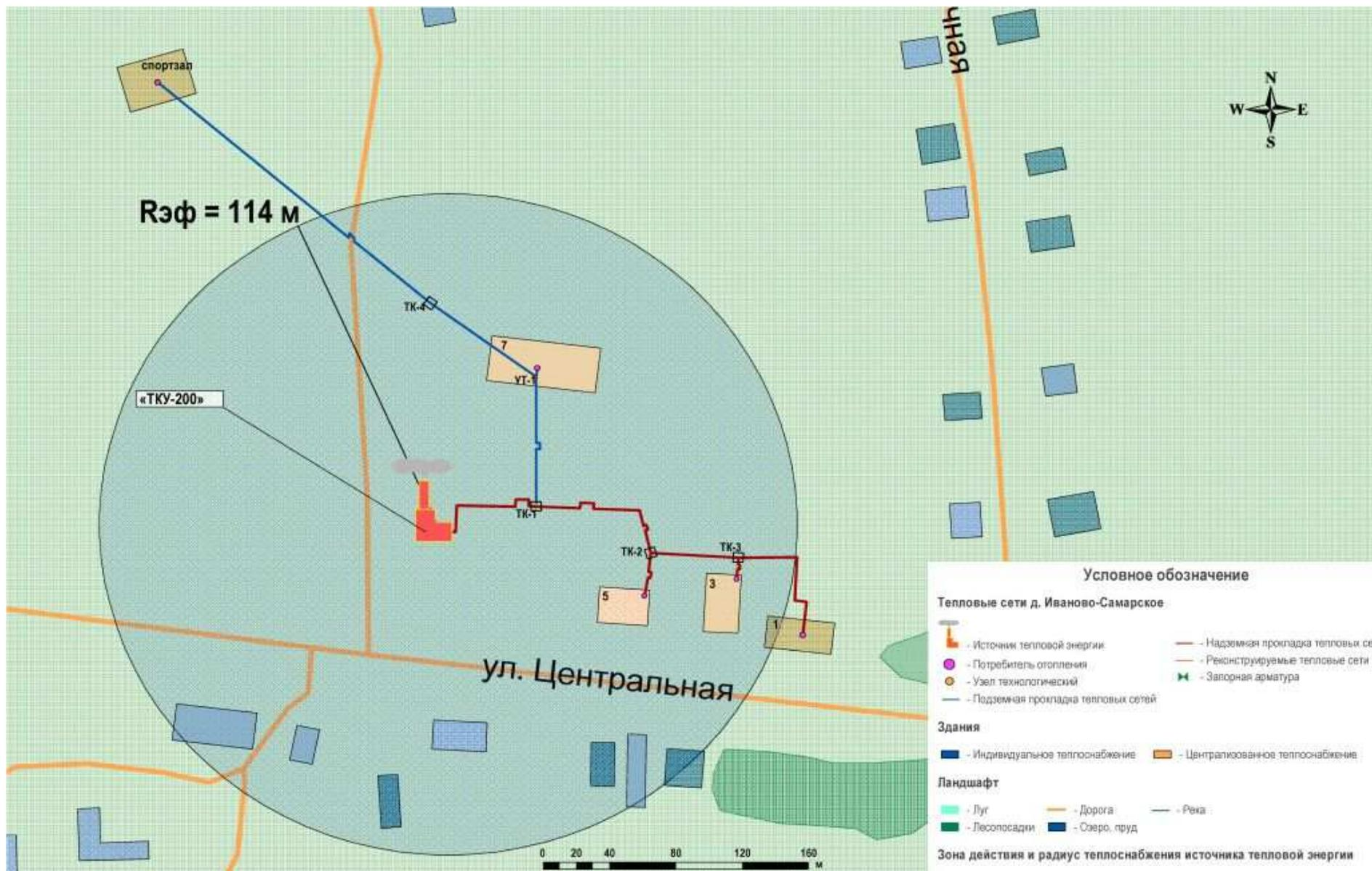
Рис. 3.1. Схема с обозначением радиуса эффективного теплоснабжения источника тепловой энергии – котельная «ТКУ-200» д. Иваново-Самарское.
