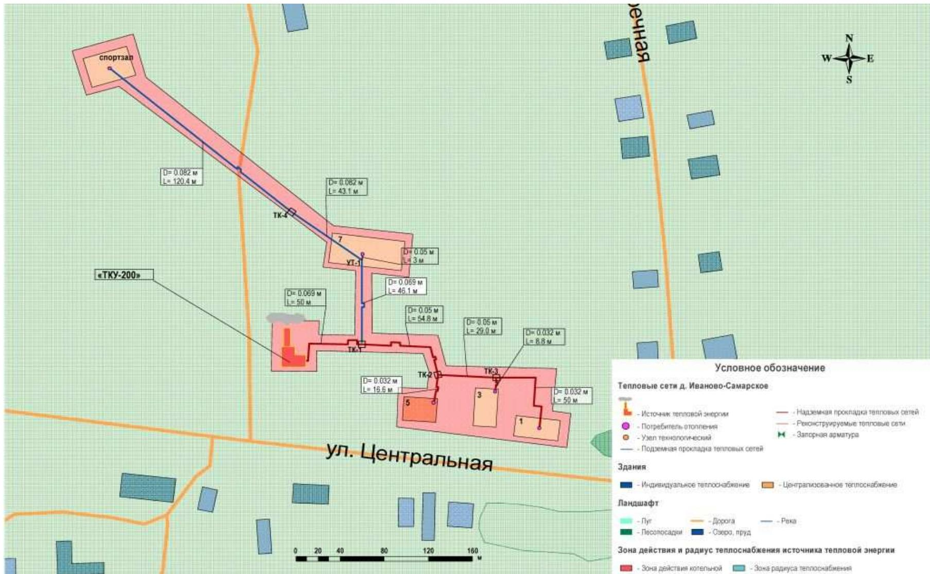
Рис. 4.1. Перспективная зона действия системы теплоснабжения и источника тепловой энергии – котельная «ТКУ-200» д. Иваново-Самарское.
