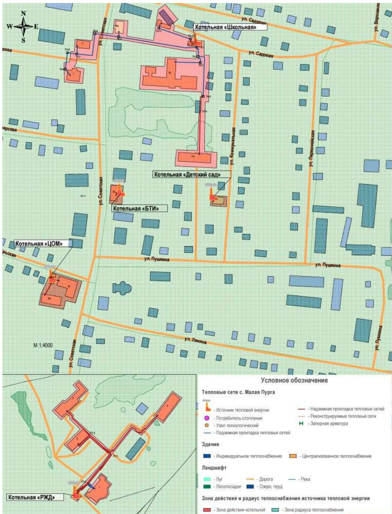
Рис. 3.9. Существующая зона действия системы теплоснабжения и источников тепловой энергии – котельных «ЦОМ», «Школьная», «БТИ», «Детский сад» и «РЖД» с. Малая Пурга.
