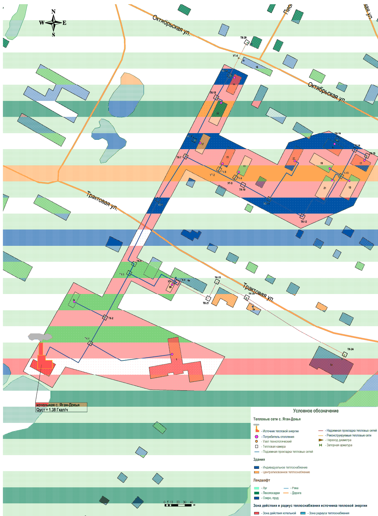
Рис. 3.4. Существующая зона действия системы теплоснабжения и источника тепловой энергии – котельная с. Яган-Докья МО «Бурановское».
